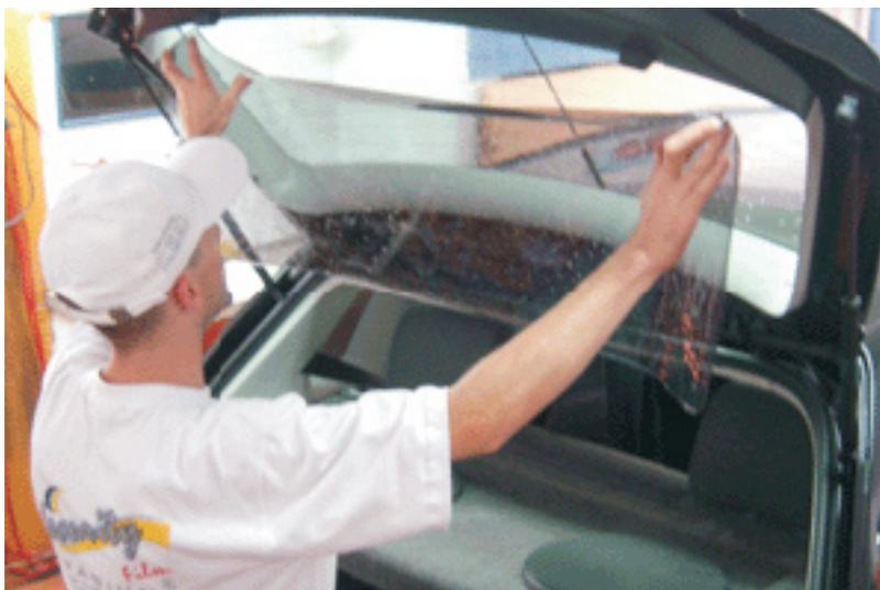
Fazendo uso de um rodo azul ou amarelo, chamados "rodos duros", retire a solução de montagem que ficou entre o vidro e a película Titanium®.
