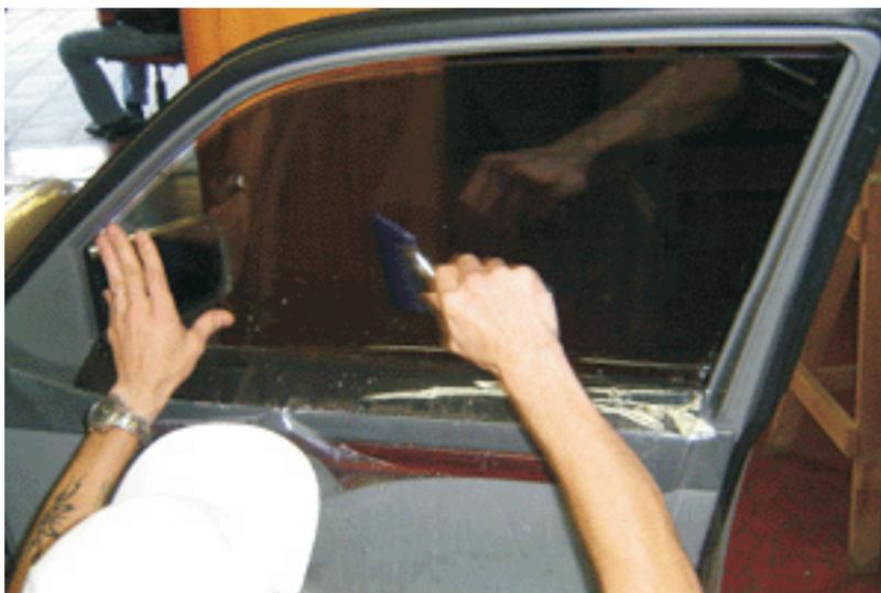
Com a película Titanium® bem montada sobre o vidro, recorte as sobras, usando um estilete. O recorte deve ser feito com extremo cuidado. Verifique, agora, se ainda restaram bolhas de ar ou de água, pois quanto mais cedo forem detectadas, mais fácil será de eliminá-las.
