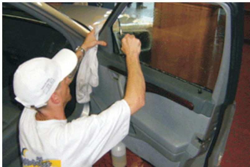
**O segredo de uma boa instalação de película é uma boa limpeza. A película Titanium® não ficará bem instalada a menos que o vidro esteja muito limpo. Para obter mais dicas sobre a limpeza do vidro, vá até o TBA-02, que fala sobre detecção de sujeira no vidro.**
